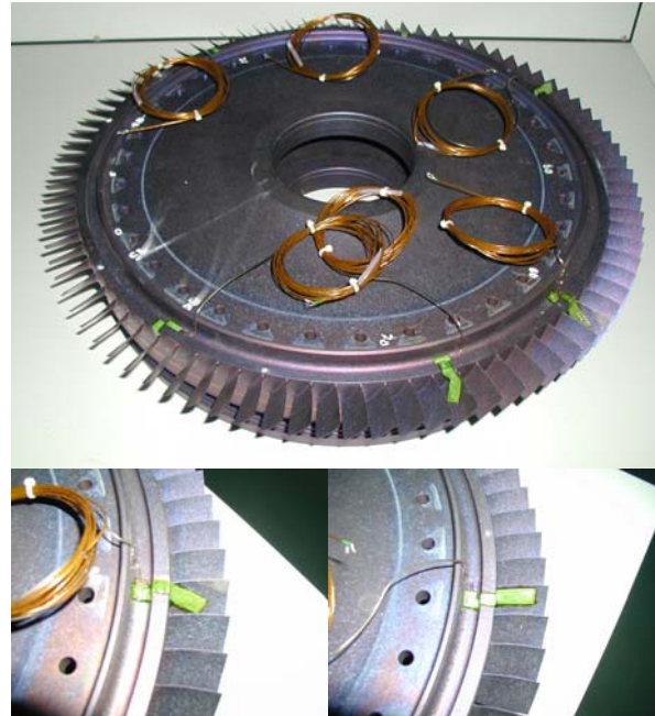
BILD 15: DMS-Instrumentierung einer Testblisk
