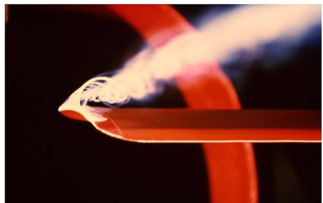
FIG 2. Randwirbel am Tragflügel (Foto: I. Rechenberg)
