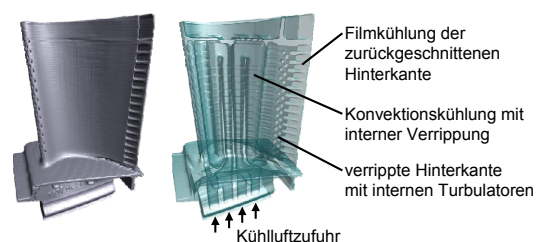
BILD 1. Gekühlte Turbinenlaufschaufel
