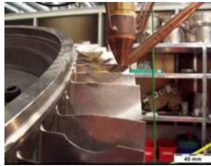
BILD 16. Starrer Laserkopf zum Laser-Auftragsschweißen von Blisk-Schaufelkanten
