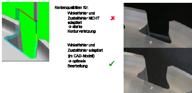
BILD 15. Nicht adaptiertes und adaptiertes Entgraten einer Schaufelnut mit Winkel- und Zustellfehler
