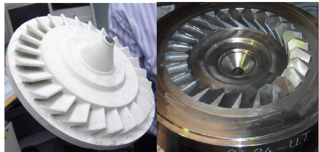
BILD 6. Abdruck und Gesenk einer Hochdruckverdichter Blisk mit konturnah geschmiedeten Schaufeln
