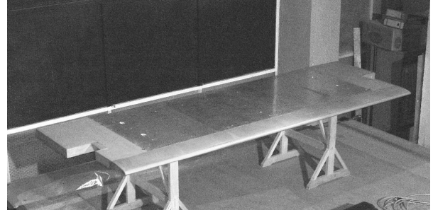
BILD 9. Anlaufkontur mit Grenzschichtabsaugung
