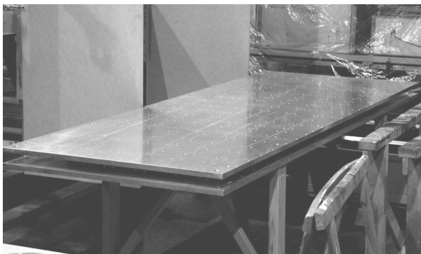
BILD 8. Unterlage mit Absaugbohrungen vor dem Einbau
