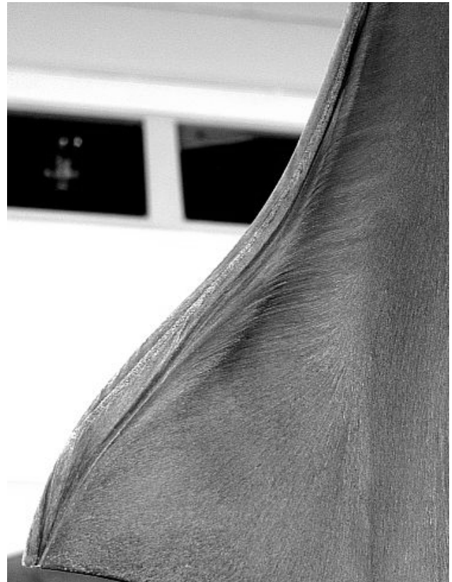
Bild 7 Strömungssichtbarmachung: Flügelende Oberseite, \alpha=17^\circ
