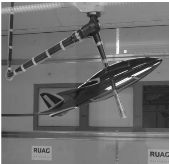
Bild 6 Modell an Aufhängung mit Stielattrappe zur Aufhängungsinterferenzbestimmung.
