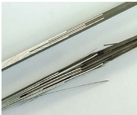
BILD 21. Übergangsbereich zum CFK/Ti Hybridlaminat vor und nach dem statischen Bruchtest
