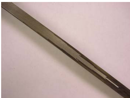
BILD 22. Übergangsbereich zum CFK/Ti Hybridlaminat unter Einsatz von 0.125mm Folien
