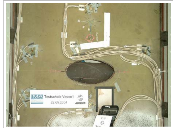
BILD 6. VeSCo Prüfschale mit eingebrachtem „large damage“
