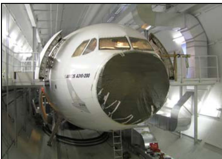
BILD 1: Rumpfabschnitt in der Niederdruckkammer beim Fraunhofer Institut IBP.
