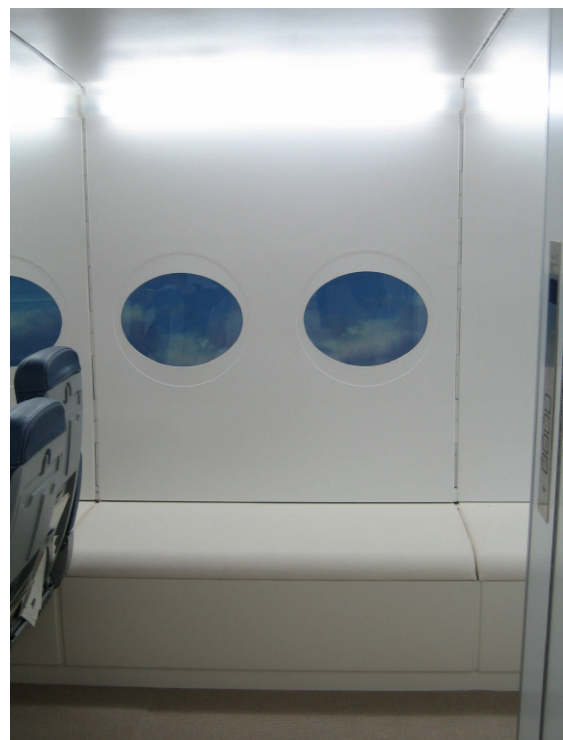
Bild 28: Funktions mock up, Panel mit Screens
