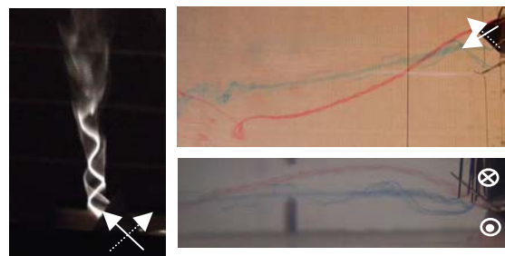
BILD 6. Mischungsverstärker in gekreuzter Scherschicht im Windkanal (links) und im Wasserkanal (rechts)
