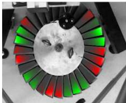
BILD 5 Schwingungsvisualisierung einer BLISK
