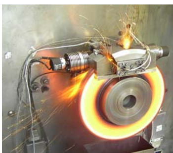
BILD 4: DLR-ROBODRIVE- die mechatronische, geregelte, selbstverstärkende Keilbremse. Antriebstechnik im Einsatz bei eStop
