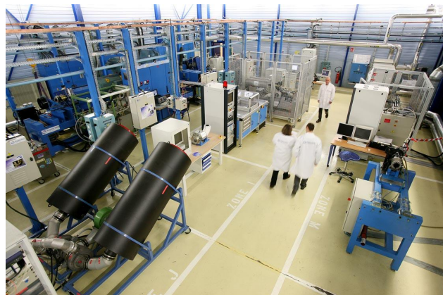
BILD 4. Flugzeugsystemprüfstand „ASVR Aircraft System Validation Rig“ (Quelle: Hispano-Suiza)
