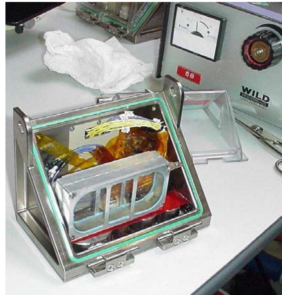
BILD 3. Standard BIOLAB Experiment Container (EC) mit abgenommenem Deckel und einem „Mini-Aquarium“ mit den Seeigellarven.
