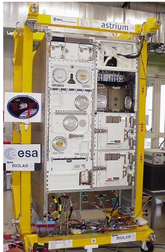
BILD 1. Die BIOLAB Flugeinheit während des Bio-Kompatibilitätstests im Herstellerwerk EADS-Astrium in Toulouse (F). Links im Bild ist der automatische Teil mit dem Inkubator, darüber der Einschub mit dem Roboter sowie Kühlfächer und Analyseinstrumente. Rechts ist der manuelle Teil mit dem Handschuhkasten und darunter zwei Kühl- oder Gefrierschränke.
