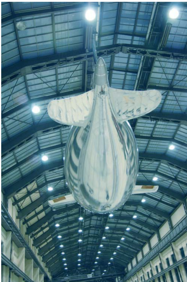
BILD 9. b-IONIC Airfish Testflug in der P.-Behrens-Halle.
