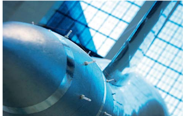
BILD 2. Ionenstrahlantrieb mit zwei Kaskaden am Heck.
