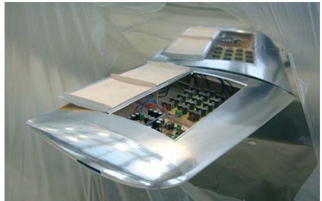
BILD 10. b-IONIC Airfish Flügel mit Generator/Batterien.
