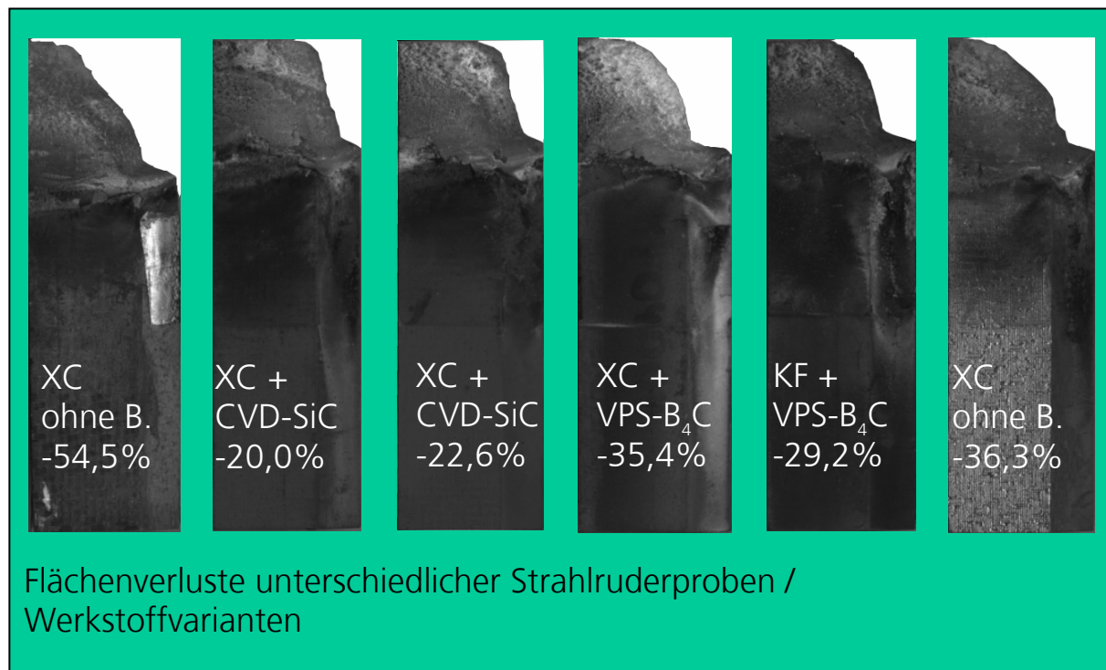
Bild 14: Strahlruderproben aus unterschiedlichen C/C-SiC Materialien mit verschiedenen Beschichtungen nach dem Test an der umgebauten Abrasiven Heißgasanlage mit faserverkeramischer Düse aus C/C-SiC. Die Flächenanalyse erfolgte durch optische Bildauswertung.
