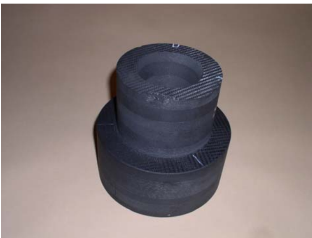
Bild 11: Faserkeramische Düse aus C/C-SiC, hergestellt durch Fügen von C/C-Platten und anschließendem Flüssigsilicieren; o.: Aufsicht auf Brennkammerseite, u.: Gesamtansicht.
