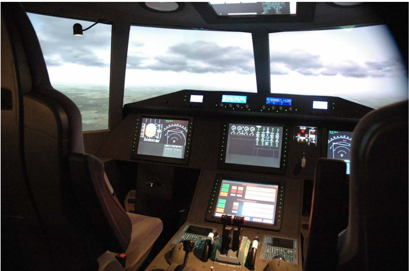
Bild 1 Forschungs-Flugsimulator mit vier TFT Bildschirmen und seriellen LCD-Displays auf dem Autopilotenpanel mit SCAMSY-Ansteuerung
