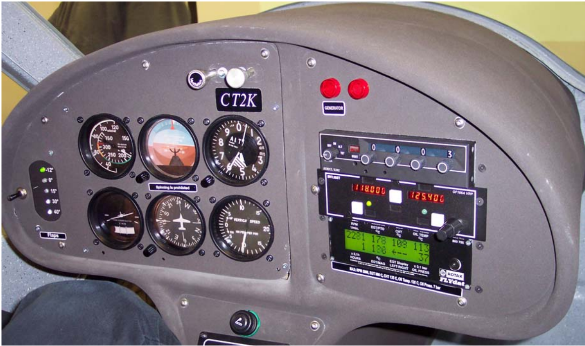
Bild 6 Instrumentenpanel eines Ultraleichtflugzeug-Simulators mit fotorealistischen SCAMSY-Instrumenten auf einem mit einer Maske versehenen TFT-Bildschirm (links) und mit seriellen LCD-Display (rechts)
