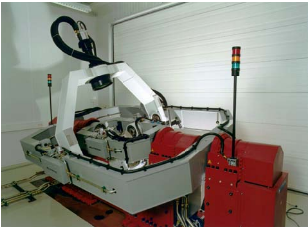
BILD 4-2 5-Achsen-Drehtisch der HIL-4-Simulation
