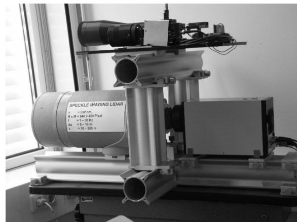
Abb. 7 Experimenteller Aufbau eines Speckle-Imaging-Lidars mit Sende- und Empfangsteleskop, MCP-CCD Kamera und gepulstem, frequenzverdoppeltem Nd:YAG-Laser (0,532 \mu\text{m} ) zur Vermessung von Luftspeckles mit Einzelpulsen und einer Kamera .
