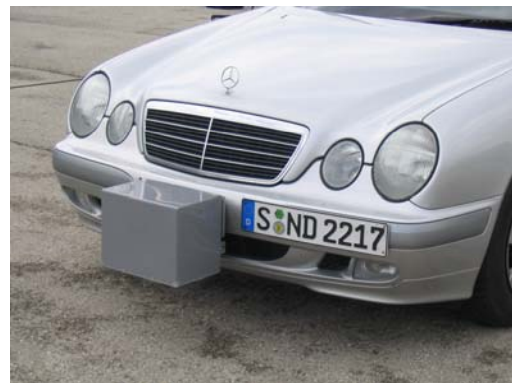
Abb. 4 DaimlerChrysler-Fahrzeug-Radar-Front-End im Versuch an der Fahrzeug-Stoßstange montiert
