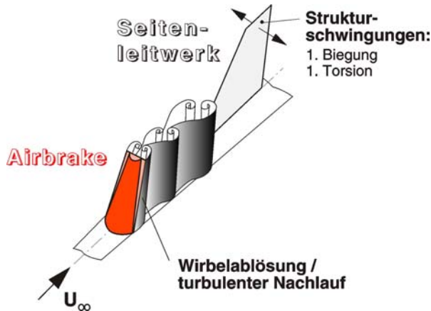
BILD 2. Phänomenologie bei Seitenleitwerksschütteln durch Nachläufe stumpfer Körper.
