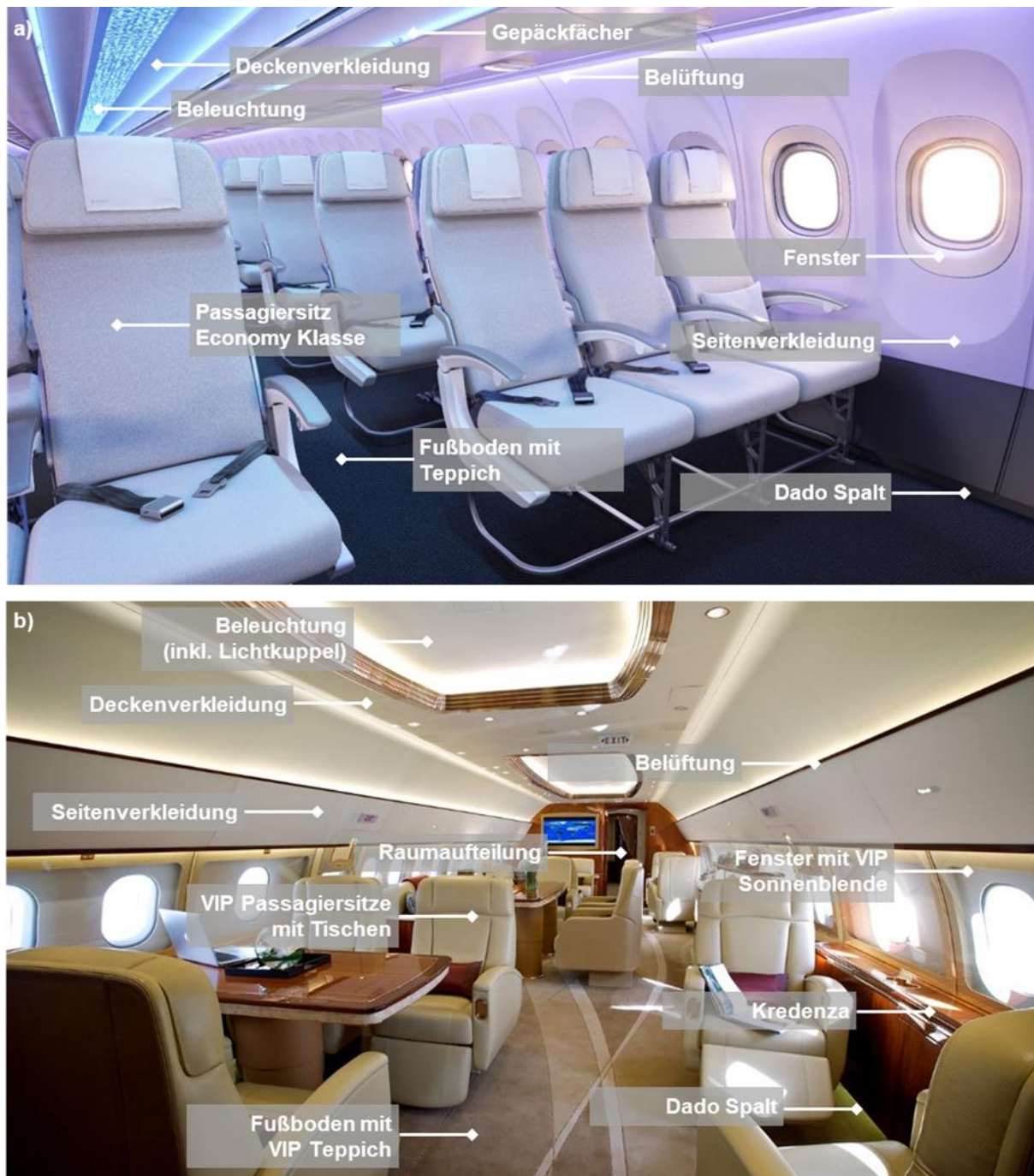
Abbildung 8: a) A320 STD-Kabine Linienfluggesellschaft, modifiziert [20] b) A319ACJ VIP-Kabine, modifiziert [21]
