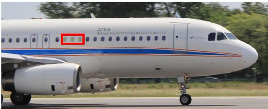
Abbildung A2.1: DLR ATRA-Testträger in Takeo mit Druck-Messwandler-Anordnung [60]
