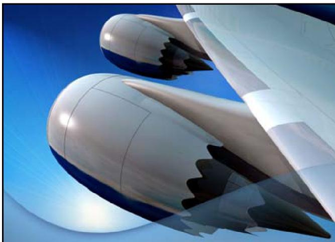
**Bild 4.6** Darstellung der Chevron-Düsen an einem Modell der 747-8 (**Stoker 2007**)
