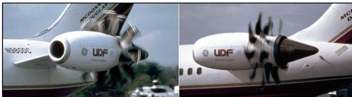
**Bild 8.11** Ein UDF Triebwerk an einer McDonnell Douglas (**Luftpiraten 2007**)
