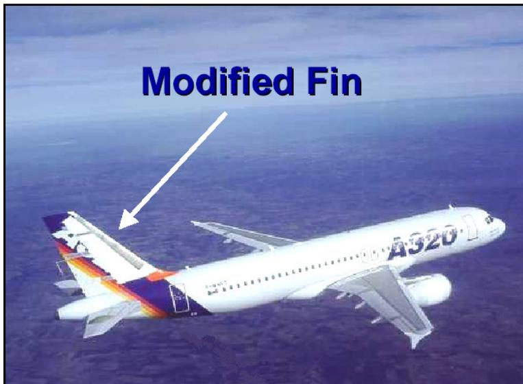
**Bild 8.8** HLFC Systems am Seitenleitwerk einer A320 (Jupp 2007)
