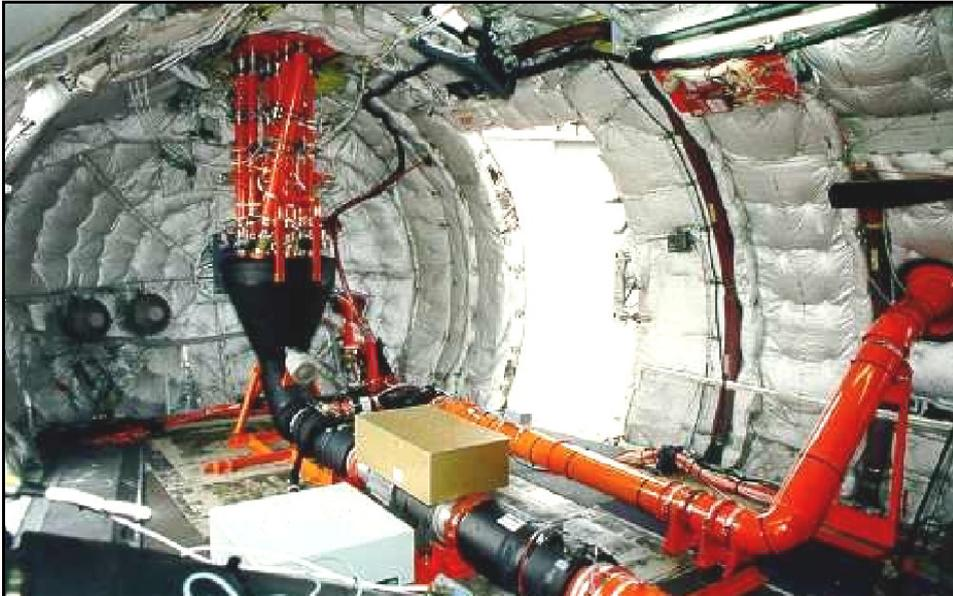
**Bild 8.7** Darstellung der Installation eines HLFC Systems im Heck einer A320 (**Jupp 2007**)
