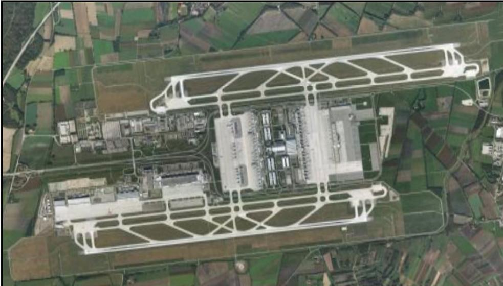
**Bild 5.5** Anlage des Flughafens München mit kurzen Rollwegen zur Startbahn 08L bzw. 26L (Google Earth 2007)
