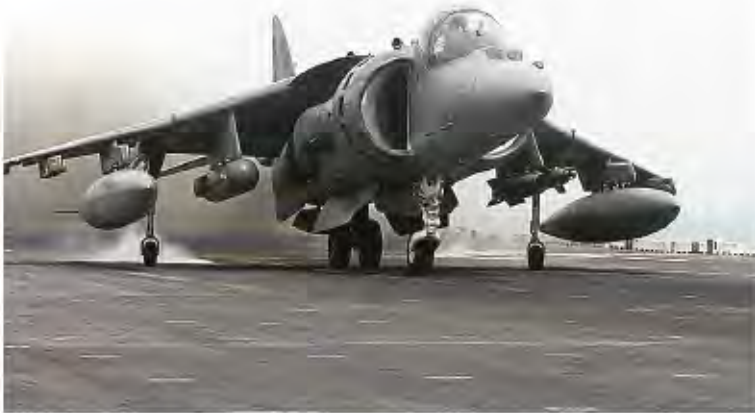
Bild 4.30 McDonnell Douglas AV-8B Harrier II mit Tandemfahrwerk (Wikipedia 2012b)
