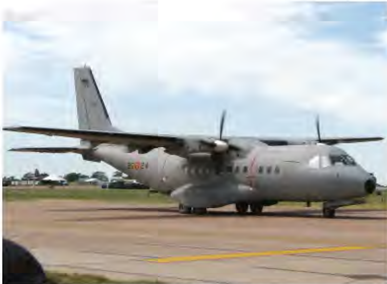
Bild 4.33 Airbus CN235 mit ausgelagertem Rumpffahrwerk (Wikipedia 2012e)
