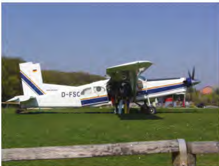
Bild 4.29 Pilatus PC-6 Porter mit Spornradfahrwerk (Wikipedia 2012a)
