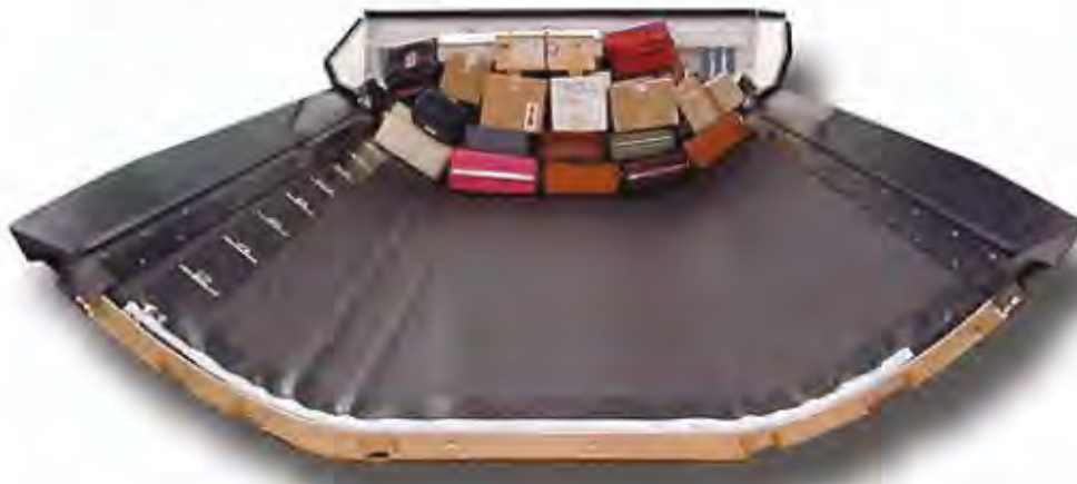
Bild 4.28 Sliding Carpet System (Telair 2012)
