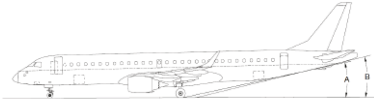
Bild 4.26 Seitenansicht der E195 mit eingezeichneten Tail Strike Angles (nach Embraer 2012)
