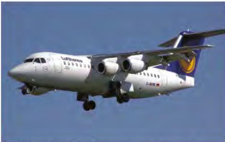
Bild 4.31 Avro RJ85 mit Bugradfahrwerk (Wikipedia 2012c)
