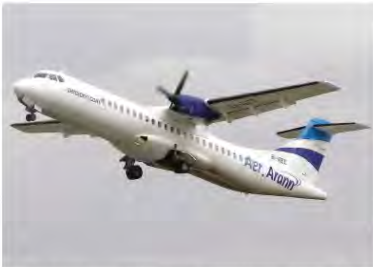
Bild 4.32 ATR72 mit konventionellem Rumpffahrwerk (Wikipedia 2012d)
