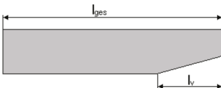
Bild 4.21 Seitenschnitt eines Frachtraums im Unterdeck
