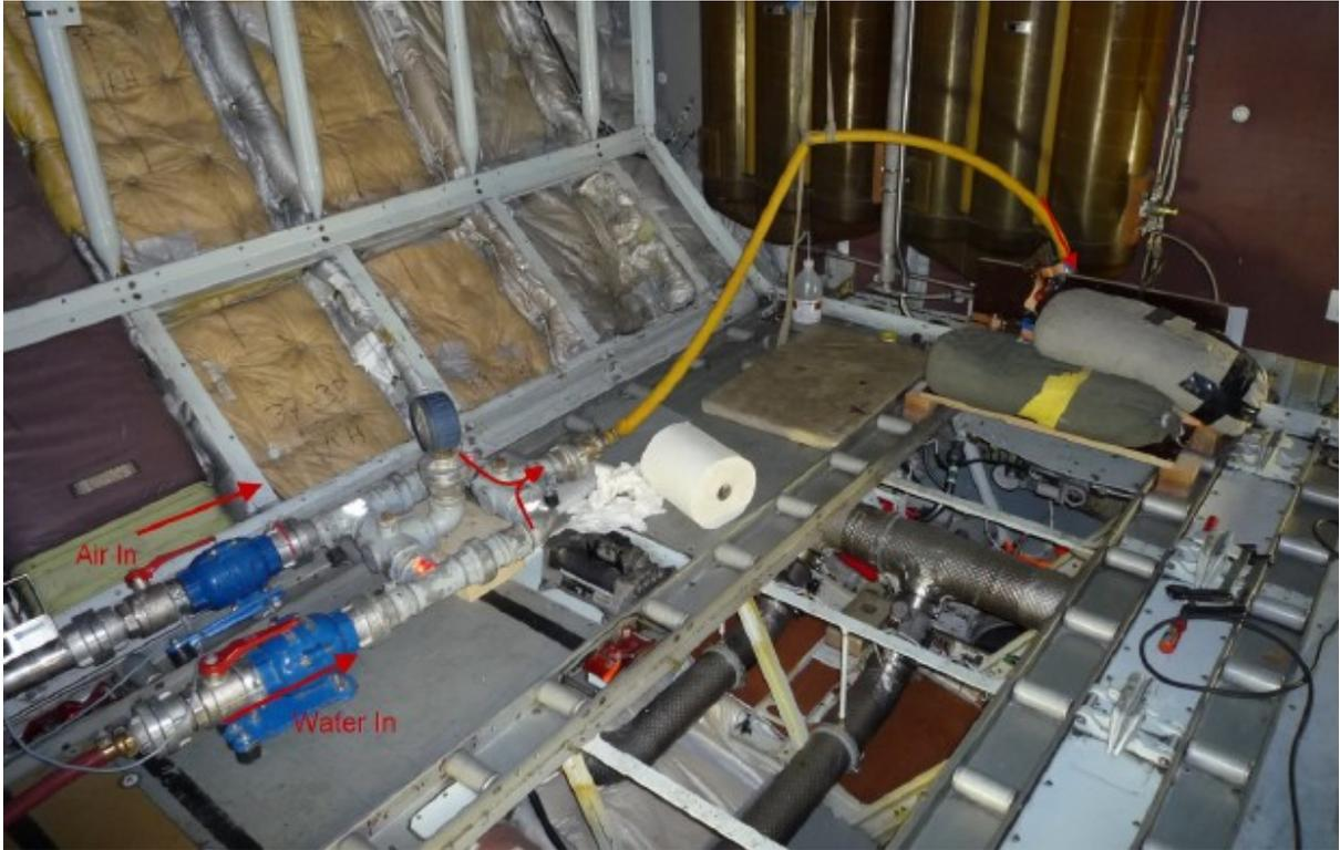
**Bild 2.17**      Complex-Testaufbau im hinteren Cargo Compartment (LHT 2016)
