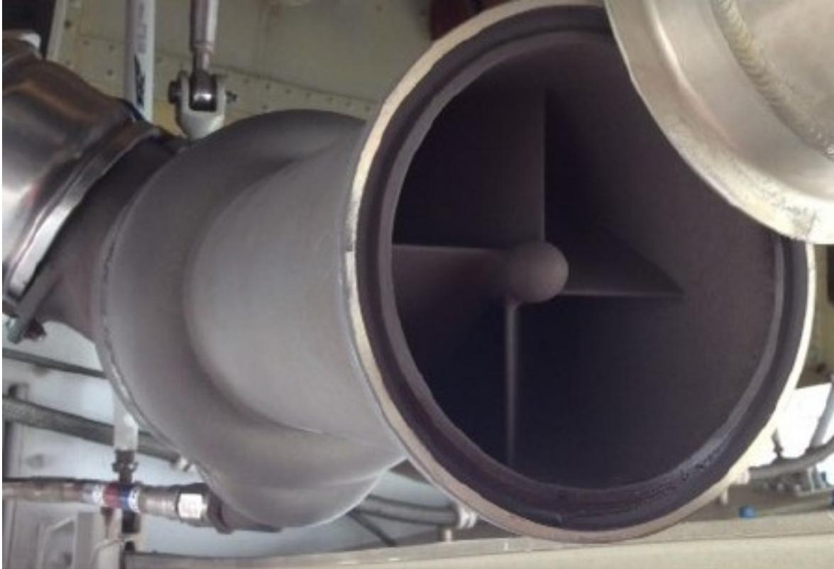
**Bild 4.6** Wasserextraktor (Scholz 2021a)
