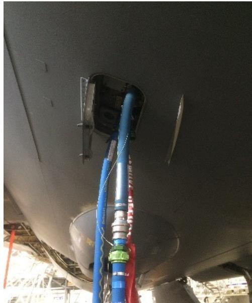
**Bild 2.9** Anschluss-Wasserservicepanel (LHT 2016)
