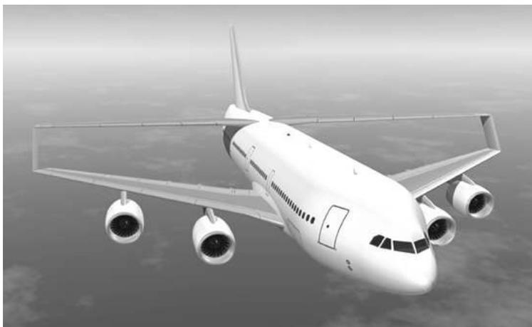
**Bild 2.11** Joint-Wing Aircraft-Idee von Airbus
