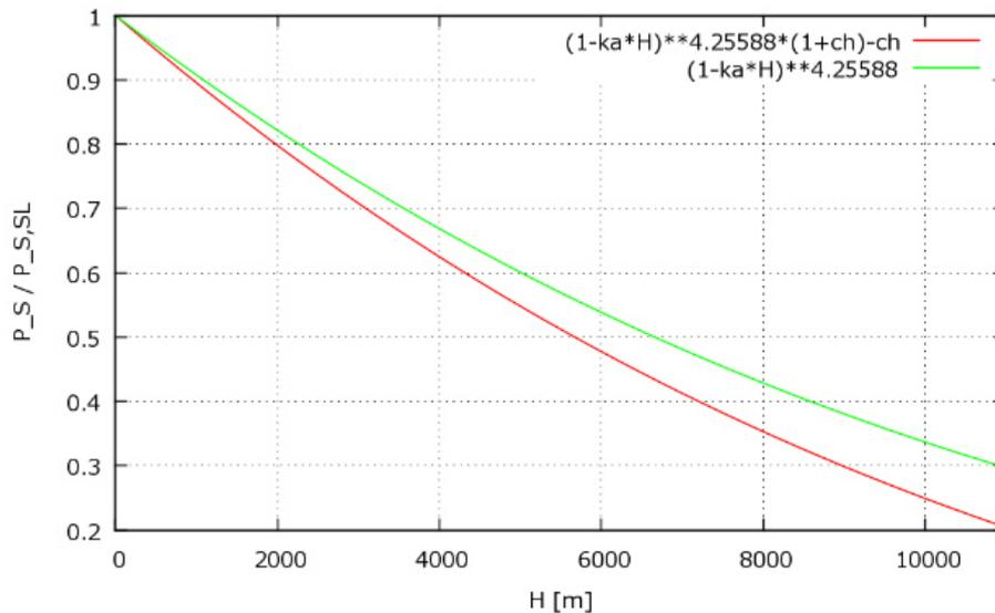
**Bild 3.1** Abnahme der Wellenleistung eines Kolbenmotors mit der Höhe (Scholz 2019)
