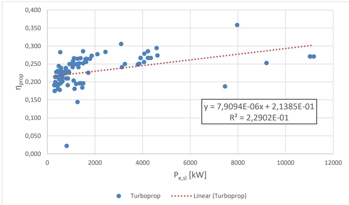
**Bild 4.9** Der Gesamtwirkungsgrad von Turboprops aufgetragen über der äquivalenten Leistung in Meereshöhe,  $P_{e,sl}$
