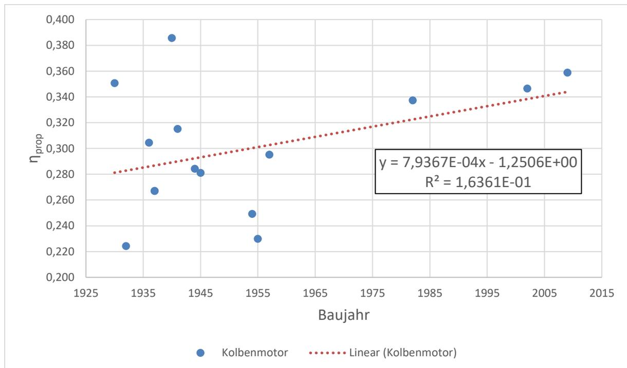
**Bild 4.10** Der Gesamtwirkungsgrad von Kolbenmotoren aufgetragen über dem Baujahr
