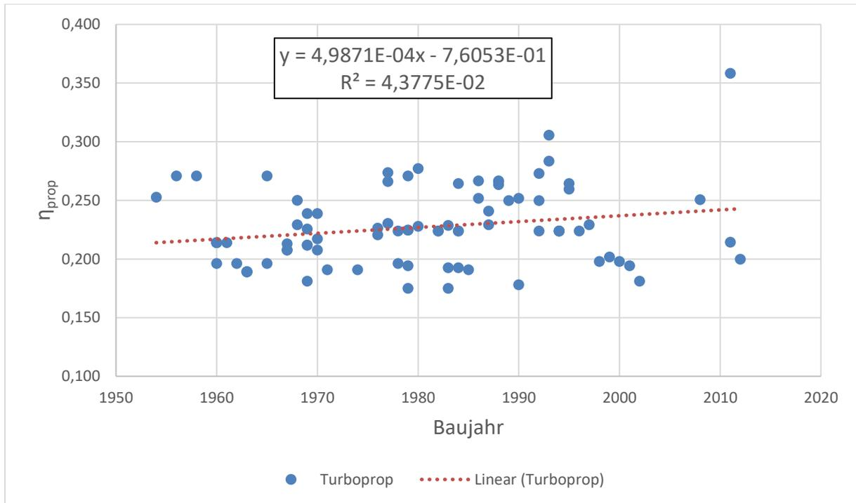
**Bild 4.7** Der Gesamtwirkungsgrad von Turboprops aufgetragen über dem Baujahr
