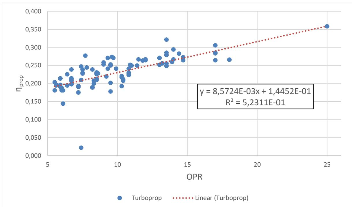
**Bild 4.8** Der Gesamtwirkungsgrad von Turboprops aufgetragen über dem Gesamtdruckverhältnis, OPR
