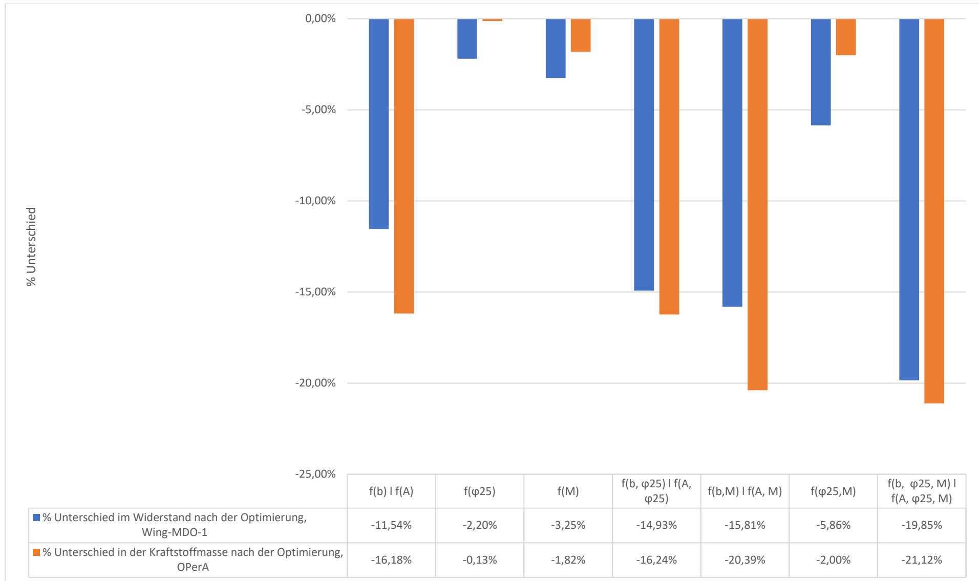
Bild 6.1 Prozentuale Unterschiede im Widerstand und in der Kraftstoffmasse nach der Optimierung mit Wing-MDO-1 und OPerA
