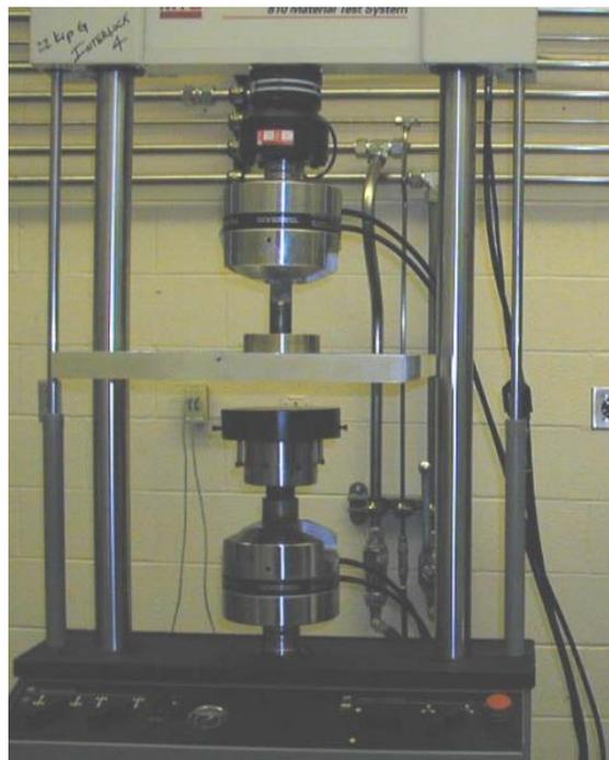
Abbildung 3-4: Testvorrichtung zur Polsterkalibrierung [34]
