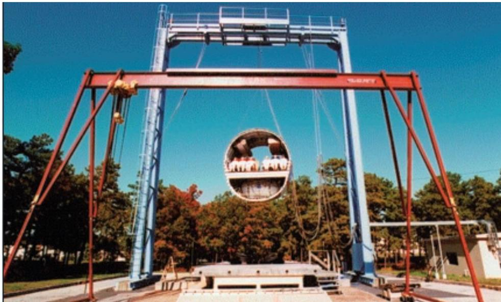
*Abbildung 1-1: Testaufbau des Falltests [4]*
