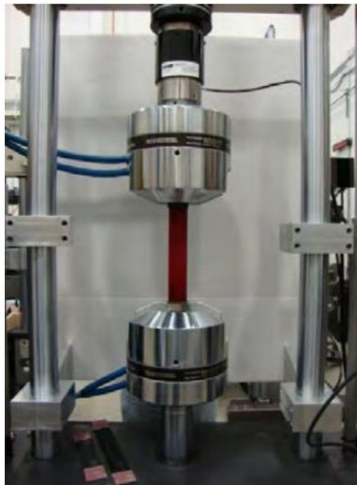
Abbildung 3-1: Eingespanntes Gurtelement zur Zugprobe [33]
