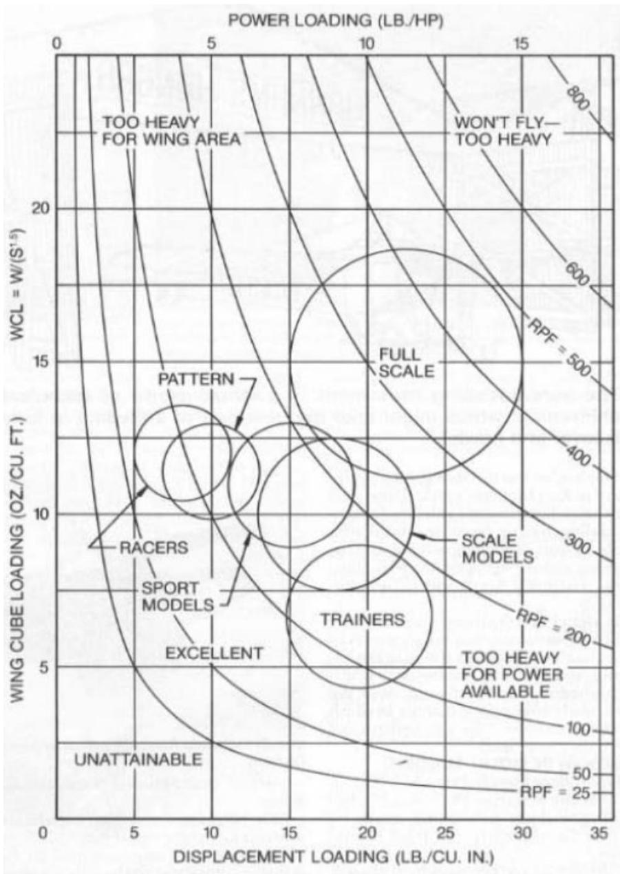
**Figure 2.4** RPF parameter for RC planes (Reynolds 1989).
