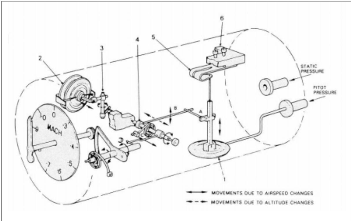
Fig.: 5-7 The analog mach meter
