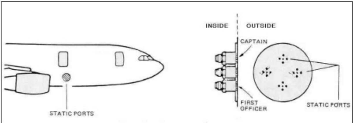
Fig.: 4-2 The static port (Bräunling)
