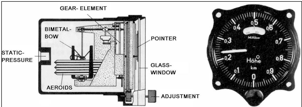
Fig.: 5-4 The analog altimeter
