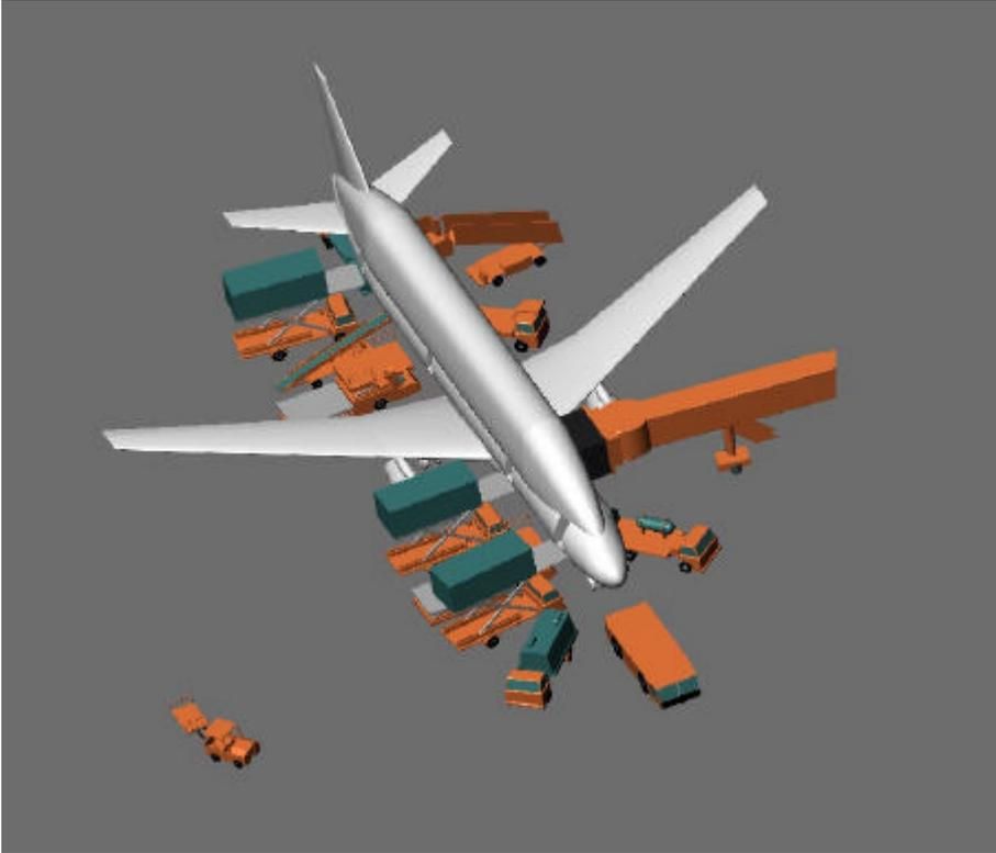
**Bild 3.37** Crp\_4, Ground Handling als 3D-“Solid-Works“-Modell
