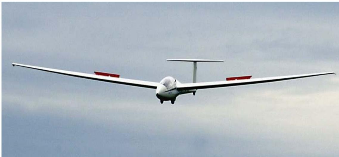
**Bild 3.2:** Segelflugzeug als Mitteldeckerkonfiguration
