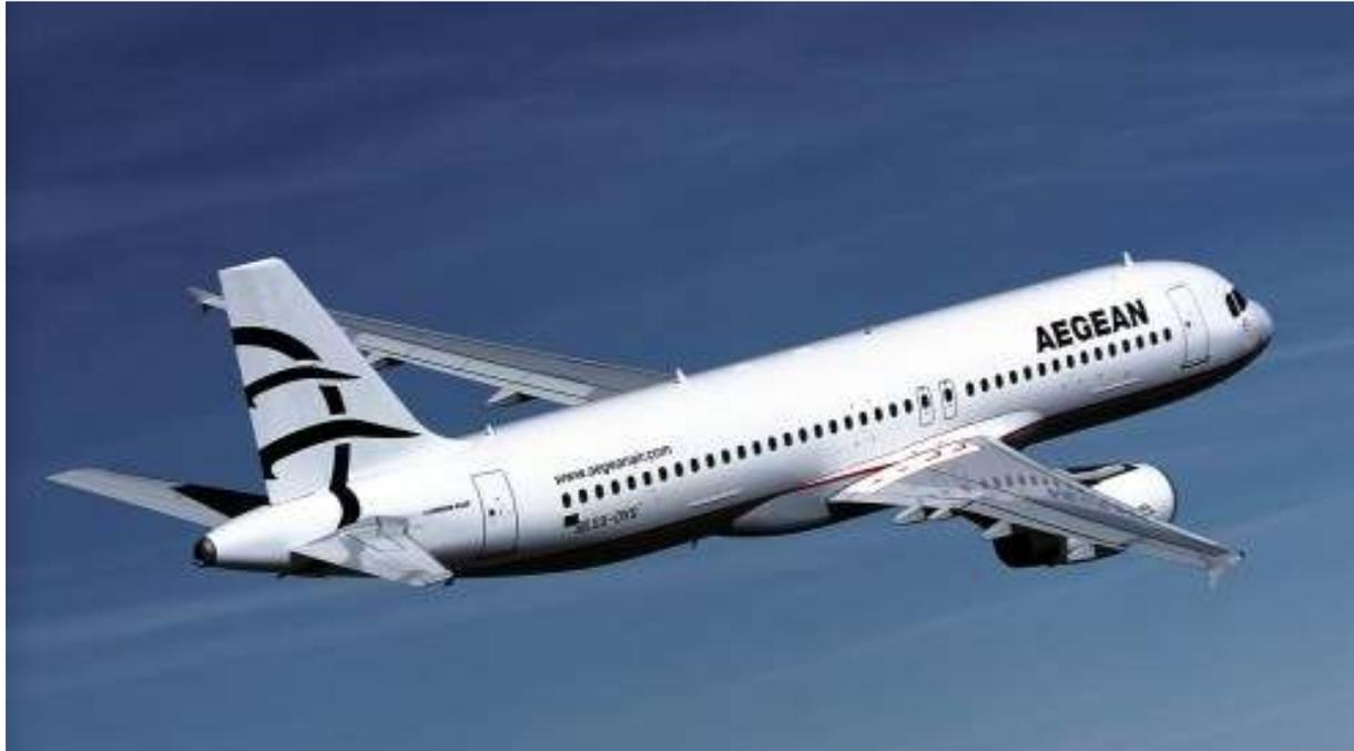
**Bild 3.1:** Beispiel eines Tiefdeckers, Airbus A320-200
