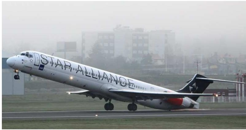
**Bild 3.13** Heckanschlag
