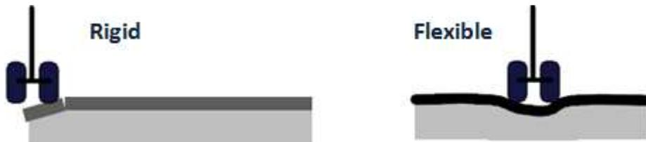
**Bild 4.1** Flexible und Rigid Pavement in Anlehnung an **Trahmer 2004**
