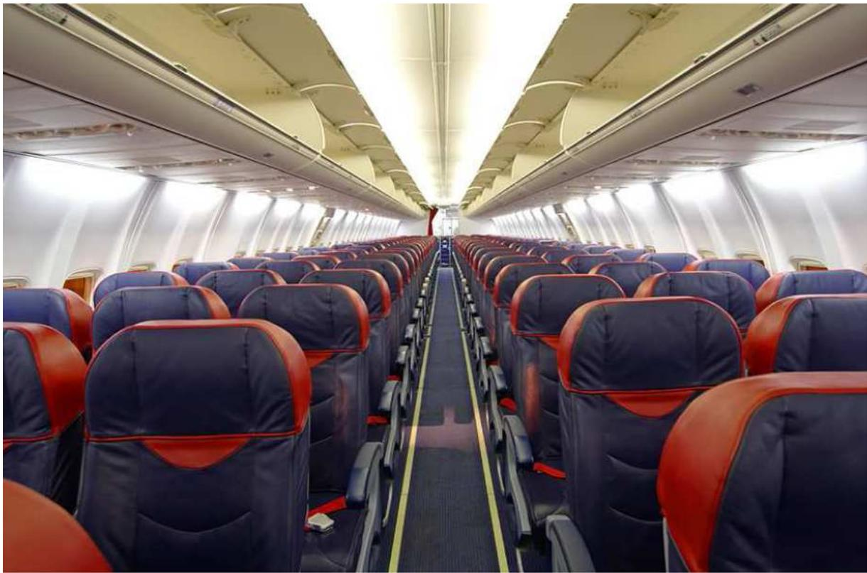
**Bild 4.9** Fixierte Gepäckablagen in der *Boeing 737 NG* ([www.boeing.com](http://www.boeing.com))
