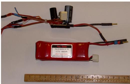
Bild 3.14 Spannungsversorgung der Messanlage
