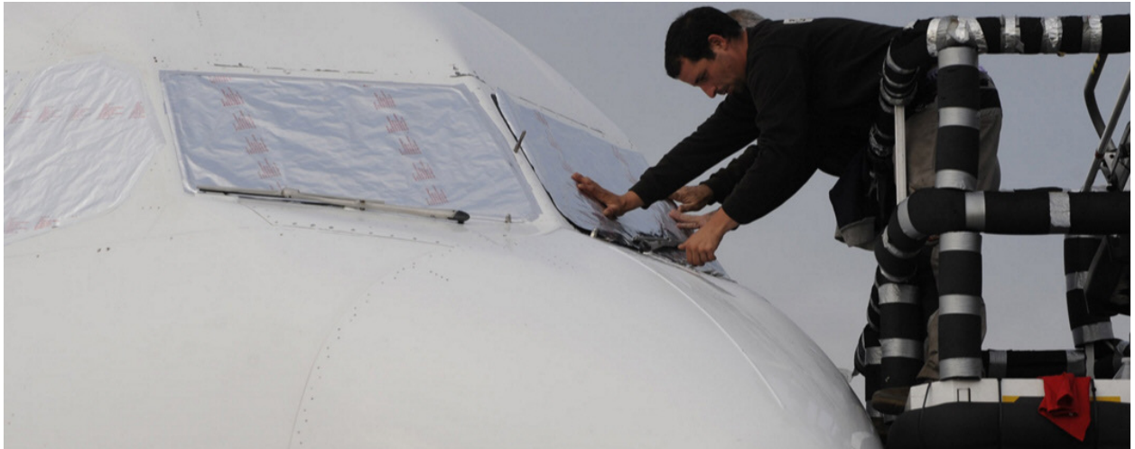
Teruel Airport, Spanien. Anbringen von Folien zum Schutz der Cockpitscheiben für ein Flugzeug, das gelagert werden soll. Quelle: https://www.tarmacaerosave.aero .
