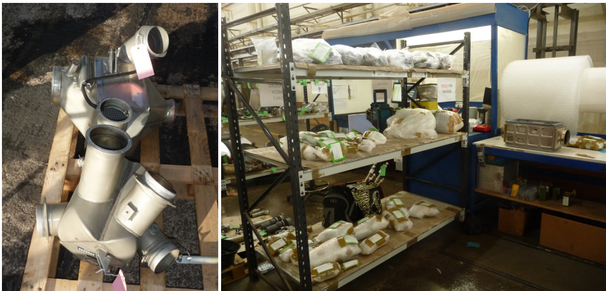
Flugzeugteile werden ausgebaut, beschriftet, auf Qualität geprüft, evtl. gewartet und zum Verkauf verpackt.
