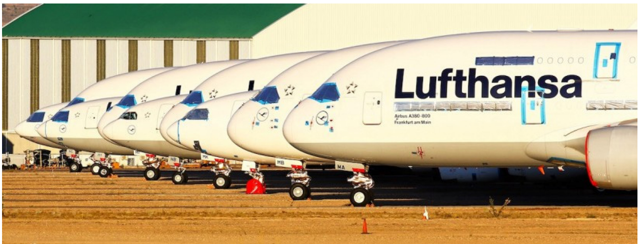
Flugzeuge sind am Teruel Airport in Spanien gelagert. Türen und Frachttore sind abgeklebt und dadurch abgedichtet. Quelle: AirTeamImages.com / Carlos Enamorado.
