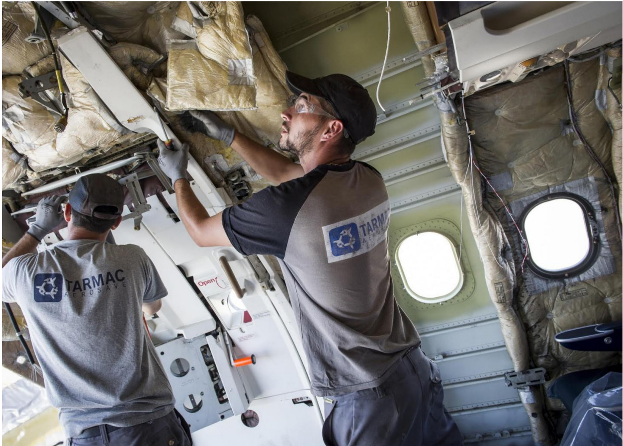
Demontage eines Flugzeugs bei Tarmac Aerosave. Quelle: Airbus, https://perma.cc/SZS7-CDBX .
