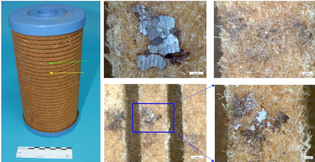
**Bild 7:** Kontaminierte Wasserfilterkartusche
