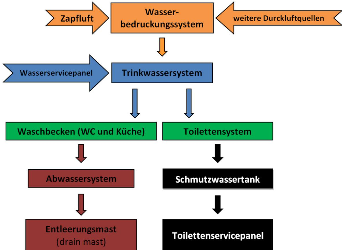
**Bild 1:** Systematik des Wasser- und Abwassersystems von Passagierflugzeugen.
