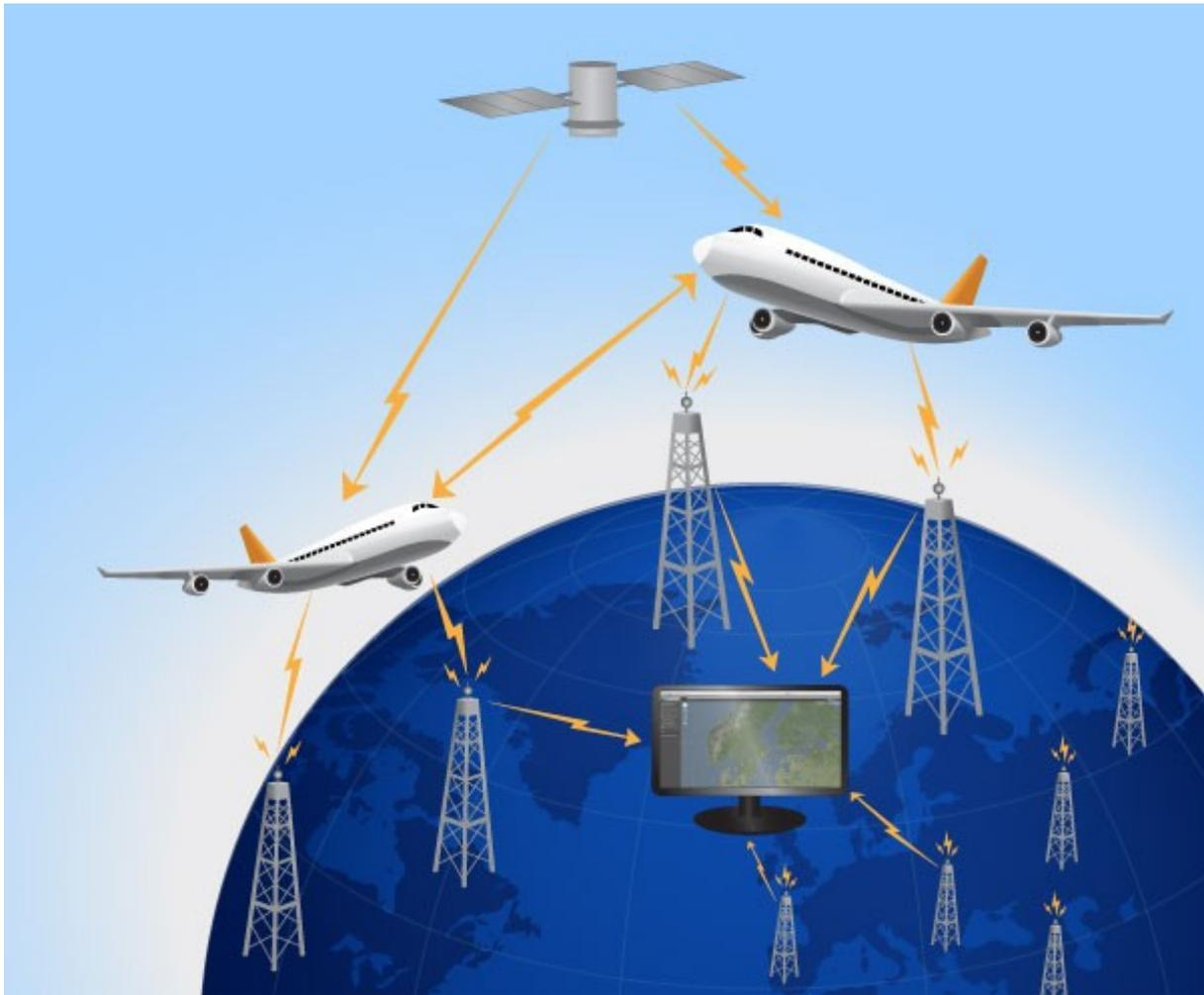
Die primäre Technologie, die Flightradar24 nutzt, um Fluginformationen zu bekommen, wird Automatic Dependent Surveillance-Broadcast (ADS-B) genannt
