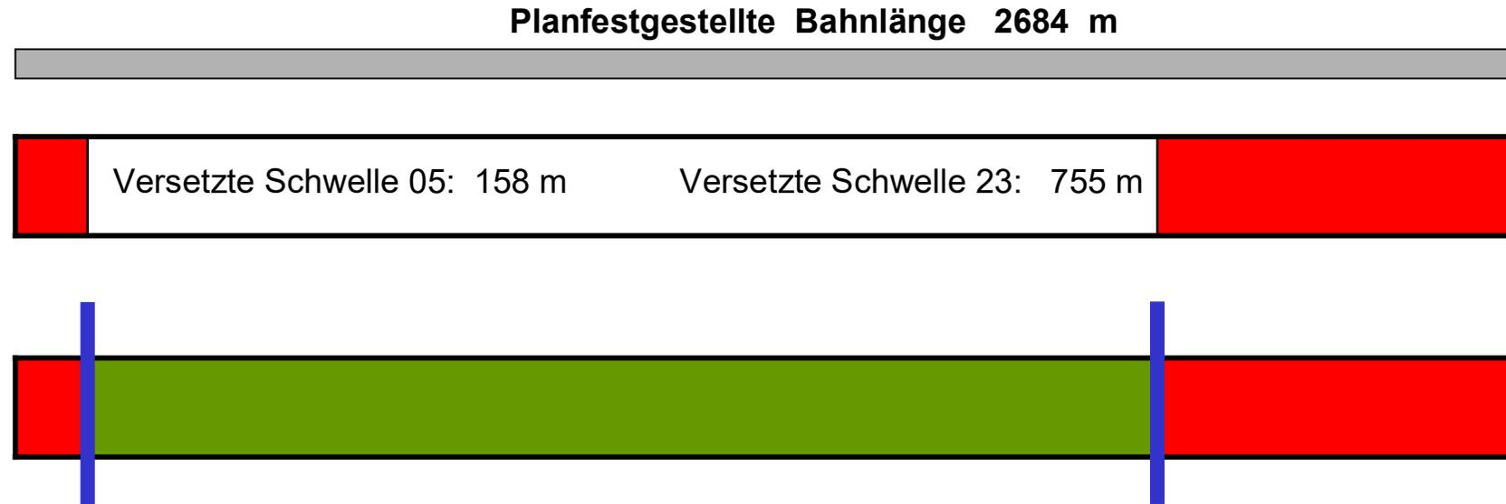
Eine Bahnverlängerung von 2321 m auf 2684 m kann nur dann optimal genutzt werden, wenn die **Schwellen** möglichst weit zu den Bahnenden verlegt werden.
