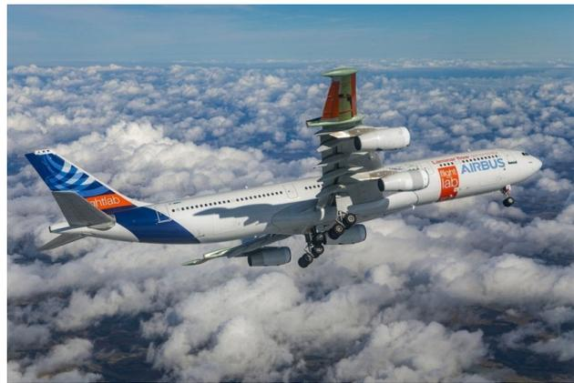
Das "BLADE"-Testflugzeug mit Laminarstruktur an den Flügeln.
