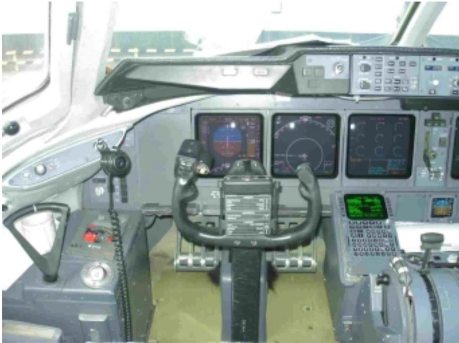
„linker Arbeitsplatz“ einer MD 11. Im Fußraum sind die Seitenruder- und Bremspedale zu erkennen, links am äußersten Bildrand der „Tiller“ für die Bugradsteuerung im Bereich niedriger Geschwindigkeiten.
