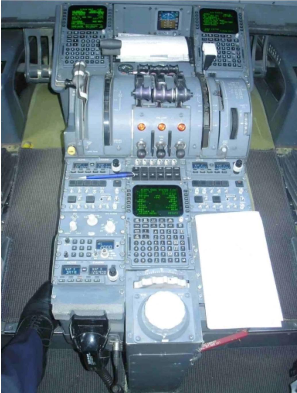
Das Bild eines MD 11 – Cockpits zeigt in der Mitte der Zentralkonsole die Schubhebel, an die vorne die Hebel für die Bedienung der Schubumkehr angeleitet sind. Links davon ist der Hebel zur Bedienung der Störklappen. Im Fussraum sind die Seitenrudderpedale zu erkennen, die mit Fussspitzenbremsen ausgerüstet sind.
