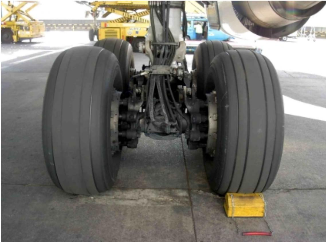
rechtes Hauptfahrwerk einer MD 11 mit Bremsanlage
