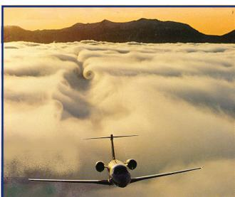
Bild 5: Ein Indiz für den induzierten Widerstand sind die Randwirbel an den Flügelspitzen. Die Randwirbel werden im Bild sichtbar an den Wolken, durch die das Flugzeug geflogen ist. [7]
